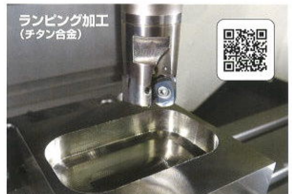
Vc=50m/min, ae=12.5mm(ae/DCX=50%), ランピング角度3° Wet Ti-6Al-4V φ25 (3枚刃) BT50
