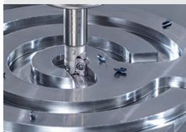
独自のV字底面インサートで、びびりを抑制！最小工具径 $\phi 6$ mmに対応可能な04サイズ追加
