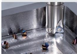
6コーナ仕様インサートで高い経済性！長い突出しでもびびりが少なく安定した高送り加工を実現
