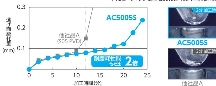
被削材: インコネル718 (44HRC) インサート: DNMG150408 切削条件: vc=100m/min f=0.15mm/rev ap=0.50mm Wet
