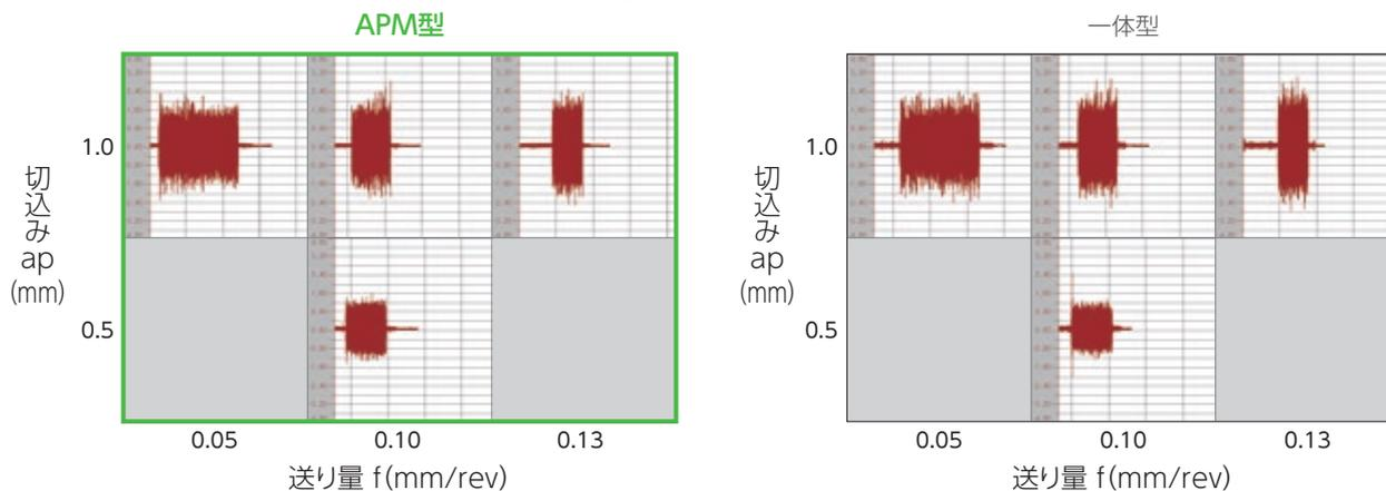
被削材: SUS420J2 使用工具 シャンク: APM-R1212X84J ヘッド: APM12-SDJCR11T3J インサート: DCGT11T302MN-SI (AC1030U)
