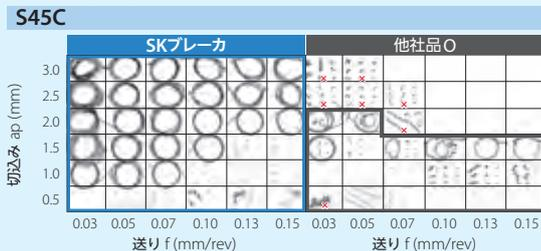
切削条件: Vc = 100 m/min, Wet, DCGT11T302タイプ ✕ 切りくず不安定
